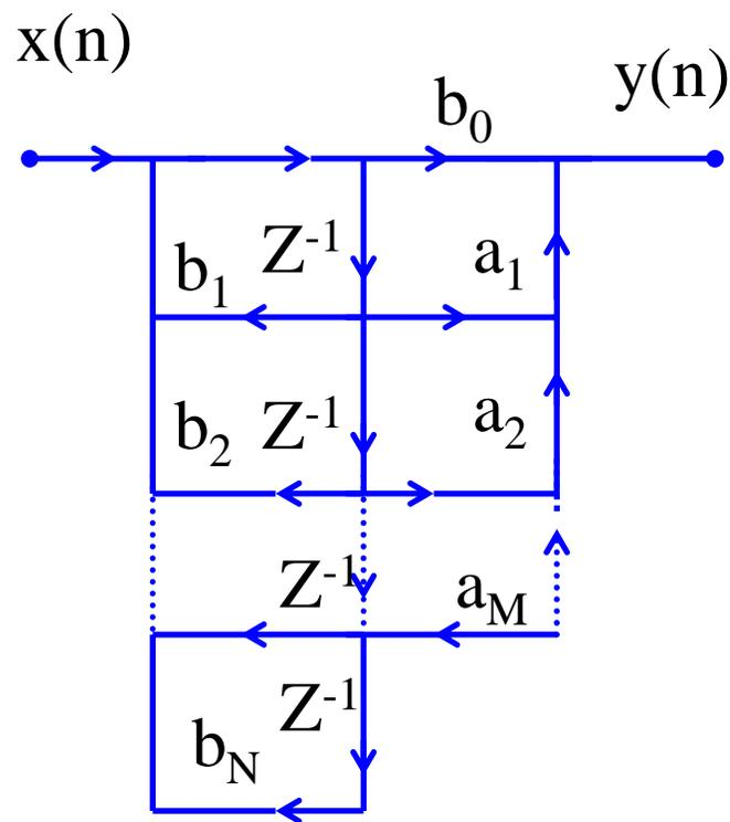
直接实现的IIR结构流图
